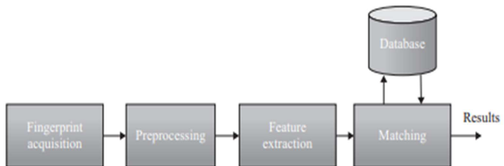
Gambar 2.3 Diagram Blok Sistem AFIS
