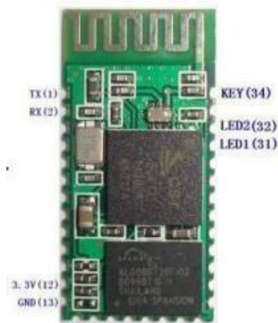
Gambar 2. 6 Module Bluetooth HC-05
